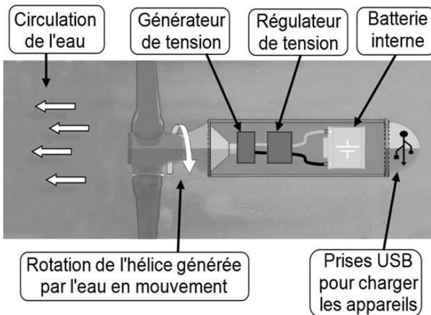
L'hydrolienne doit être immergée dans la rivière et maintenue par une cordelette.
